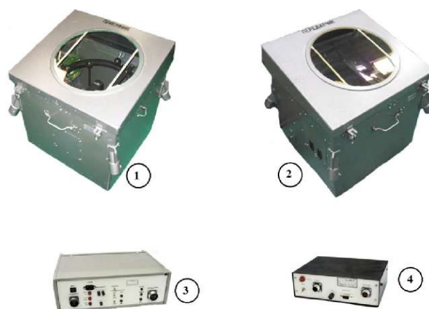
Рисунок 1 - Измеритель высоты облаков ДВО-2 1 - приемник, 2 - источник световых импульсов, 3 - блок измерительный, 4 - пульт дистанционный
